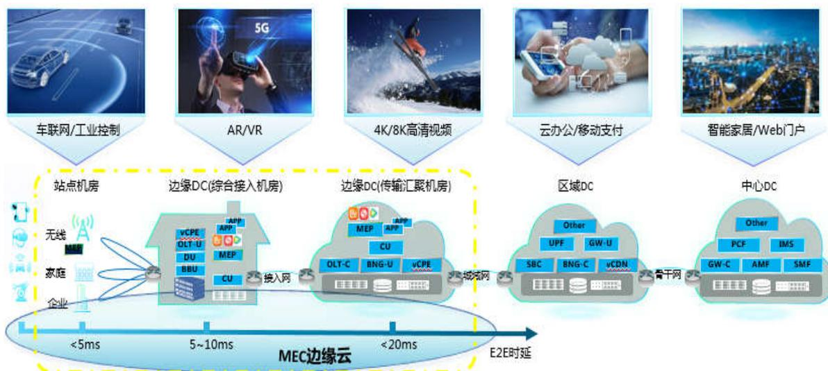
5G 核心网其天然的控制面和用户面分离属性，驱动云化网络向分布式云架构演进。
