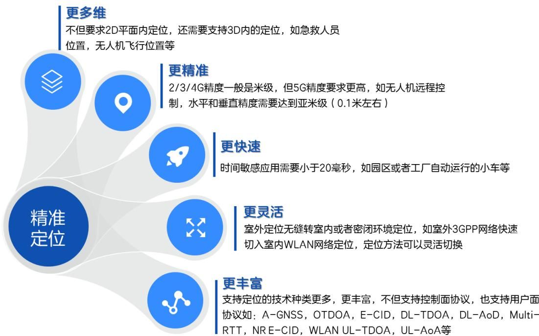
中兴通讯 i5GC 为了满足 5G 时代垂直行业用户精准定位的诉求，支持可选部署位置定位功能 LMF 服务组件。云原生 LMF 组件，具有部署资源灵活可定制，定位技术丰富的特点，对外通过能力开放接口，提供网络位置等信息，增强对第三方应用的支持，丰富定位能力。
