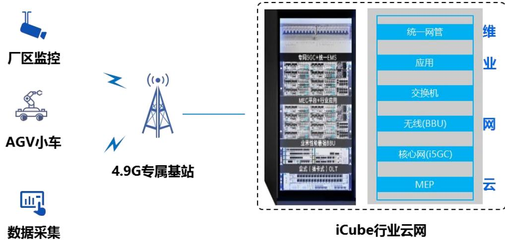
图 6-3 三一重工 5G iCube 行业云网一体架构图
