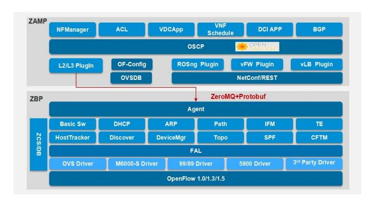
ZENIC vDC 控制器的软件结构主要分为两大部分:ZBP(基础包)和 ZAMP(管理应用包),各模块的具体说明如下:
