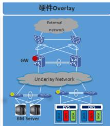
混合 Overlay 场景: VTEP 既有 OVS/DVS,也有 5960 硬件交换机(用作裸金属服务器、SR-IOV 虚机接入),网关一般采用硬件设备实现;是 SDN 下最常见的组网方案,适用于所有场景,但是最为复杂。
